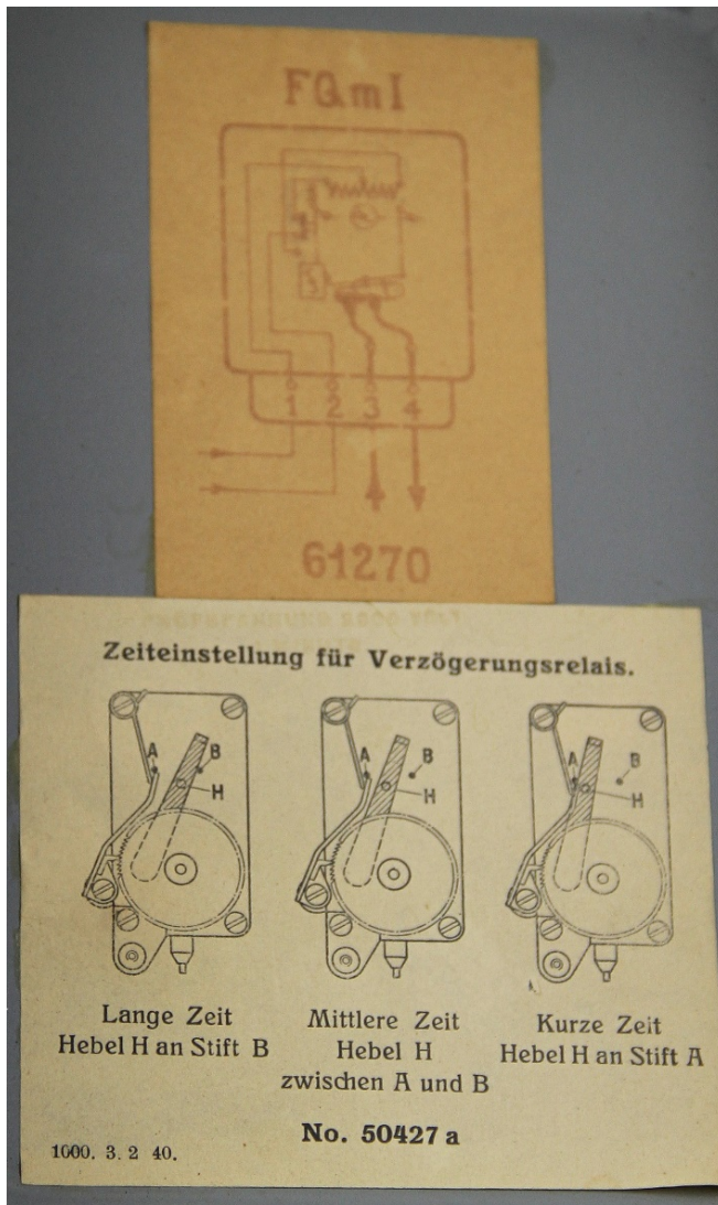
Schema aan de binnenzijde van het deksel № 50427a. (OTS 140).
