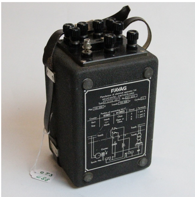
Achterzijde met schakelschema.
