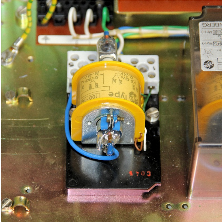
Kwikschakelaar in de kern van de spoel.
